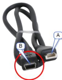
3. Insira a extremidade livre do cabo (o conector "A") na porta USB da calculadora
