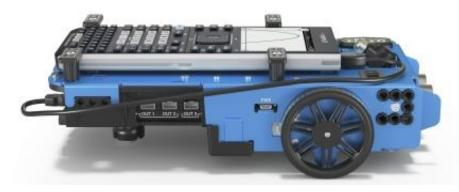
**Hinweis:** Nachdem der Hub eingefügt worden ist, greifen Sie auf drei Ports zur Steuerung der Output-Module zu.
