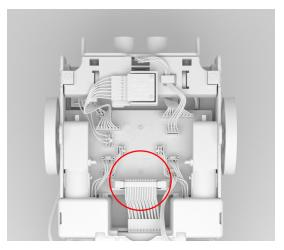
7. Stecken Sie ein Ende des  ${\bf l^2C ext{-}Kabels}$  in die Leiterplatine des Rover.
