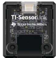
Blick von vorn: Port zur Verbindung von Sonden und Sensoren.
